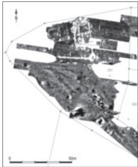
Abb. 10: Geophysikalisches Messbild (Bodenradar) mit dem Grundriss der Burg auf dem nordwestlichen Teil des Bergplateaus, in etwa 70 cm Tiefe deutlich zu erkennen (2010).
